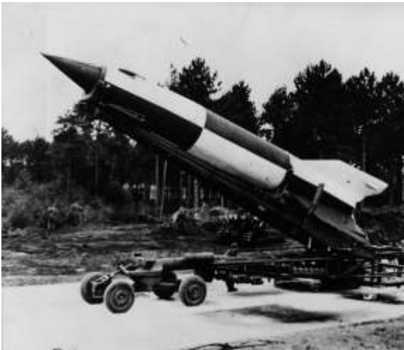
Le V-2, un impressionnant missile transportable, haut comme un édifice de cinq étages et pesant 12 tonnes; cinq mille seront tirés durant la guerre.
