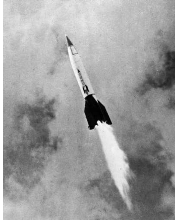
Un V-2 en vol; ce missile était capable d'atteindre l'altitude de 80 kilomètres et de franchir une distance de 320 kilomètres.
