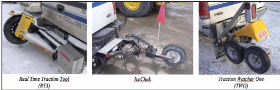
Photos 1-2-3- : Appareils de mesure continue de l'adhérence
