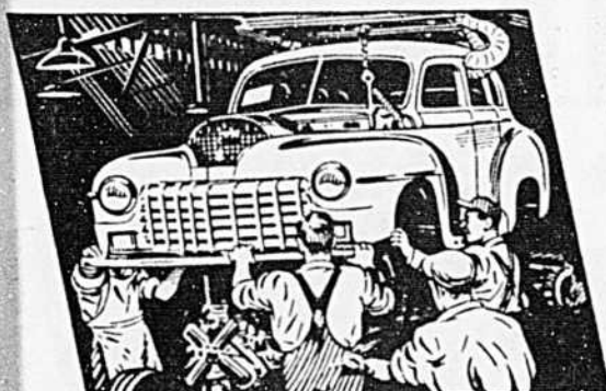
Les caisses sont hissées avec soin sur le châssis et sont solidement fixées. Les lignes de production sont synchronisées de manière à éviter tous les délais possibles.
