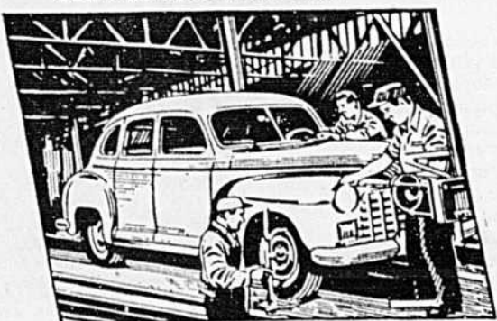
Inspection finale des moteurs, freins, lumières, roues, pneus, portières, malle, etc., en vue d'assurer que tous les standards Dodge ont été scrupuleusement suivis.
