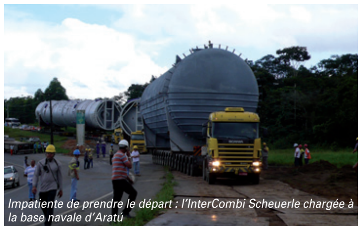
Des plaques d'acier sont utilisées pour accroître la résistance du sol, le reste est compensé par la suspension de l'InterCombi
