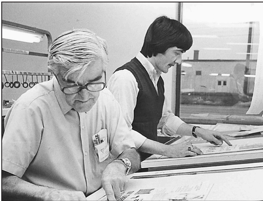
Jusqu'à l'arrivée des logiciels de mise en page dans les années 1990, les pages de journal étaient montées par des typographes comme M. Gérard Laurencelle et M. Gilles Rancourt. Les textes et les images étaient imprimés sur du papier encollé et assemblé sur une page.
