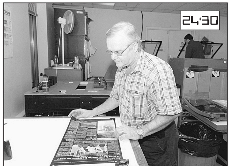
À l'atelier, Michel Morel vérifie sur une table lumineuse la page fraîchement sortie d'une imprimante. Cette pellicule servira à créer les plaques ensuite installées sur les rotatives.
