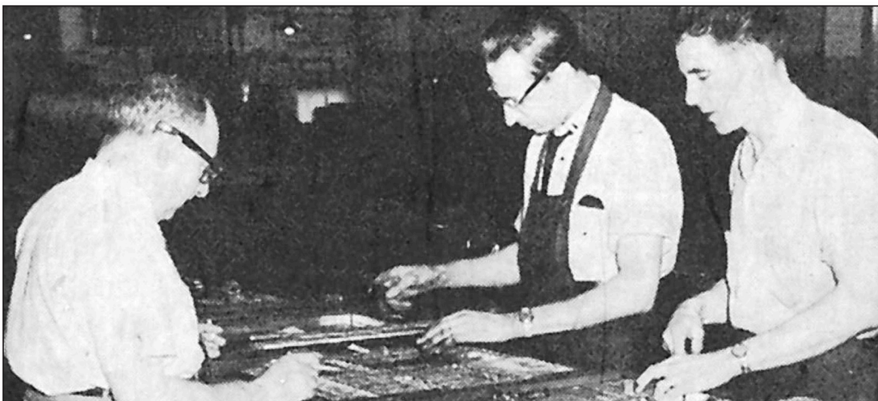
Avant l'arrivée du procédé d'imprimerie offset, la mise en page se faisait au plomb par des employés de l'atelier. Sur cette photo, M. Gérard Pépin et M. Clermont Devault, à gauche, montent une page sur la supervision de M. Jean-Marc Denault, chef de l'information.
