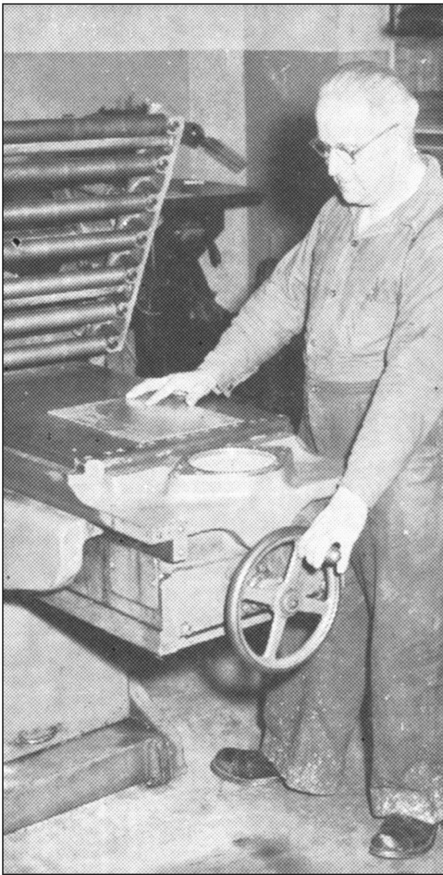
Un métier disparu: les clicheurs. Ces ouvriers, comme M. Ephreme Breton, savaient découper des lingots de plomb en de fines plaques nécessaires à la composition des pages.
