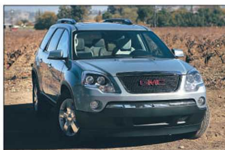
GMC ACADIA 2007 Partageant la plateforme du Buick Enclave et du Saturn Outlook, l'Acadia est le premier véhicule à châssis monocoque de GMC. Prix de base : 36 495 $
