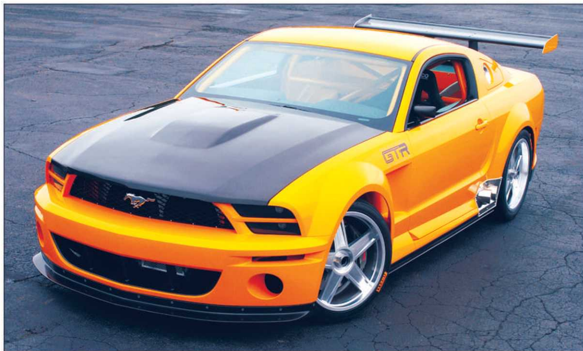
Ce qui distingue le concept Mustang GT-R, l'aile arrière en composite, qui répondrait aux exigences de plusieurs autorités de courses de route. — PHOTO FORD
