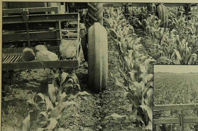
Le pneu avant à une seule nervure s'engage dans la rainure et guide le tracteur.
