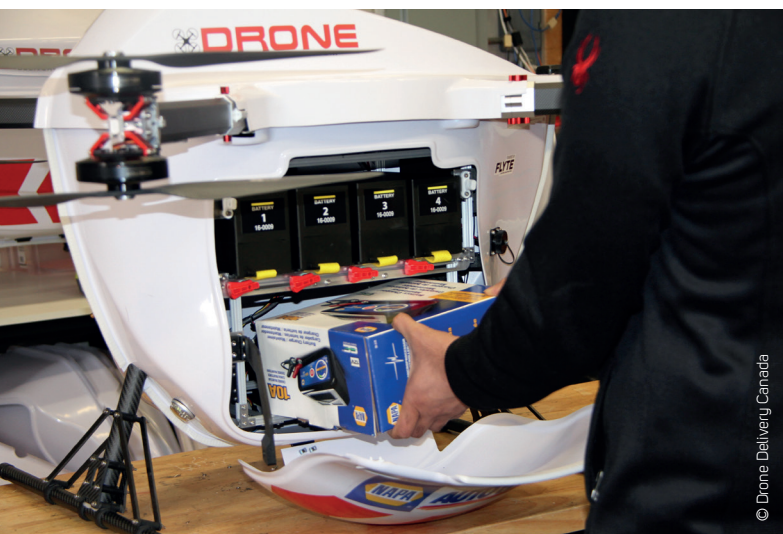
◀ Chargement d'un Sparrow électrique de Drone Delivery Canada, avec un rayon d'action de 30 km.
