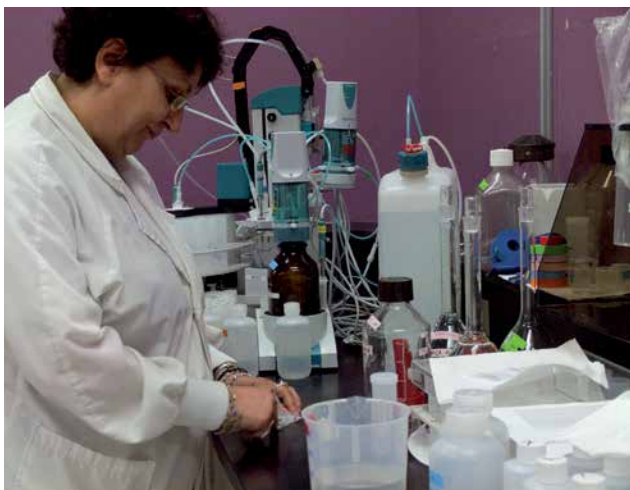
Mesure de l'alcalinité dans l'eau par Ginette Mainguy, technicienne de laboratoire (Photo : M. Jalbert, MRN).
