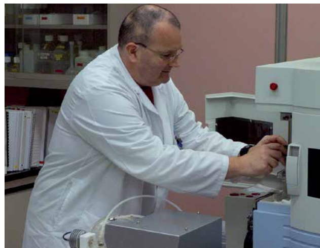
Analyse simultanée de métaux par spectrométrie d'émission atomique au plasma par Marc Bilodeau, technicien de laboratoire (Photo : M. Jalbert, MRN).
