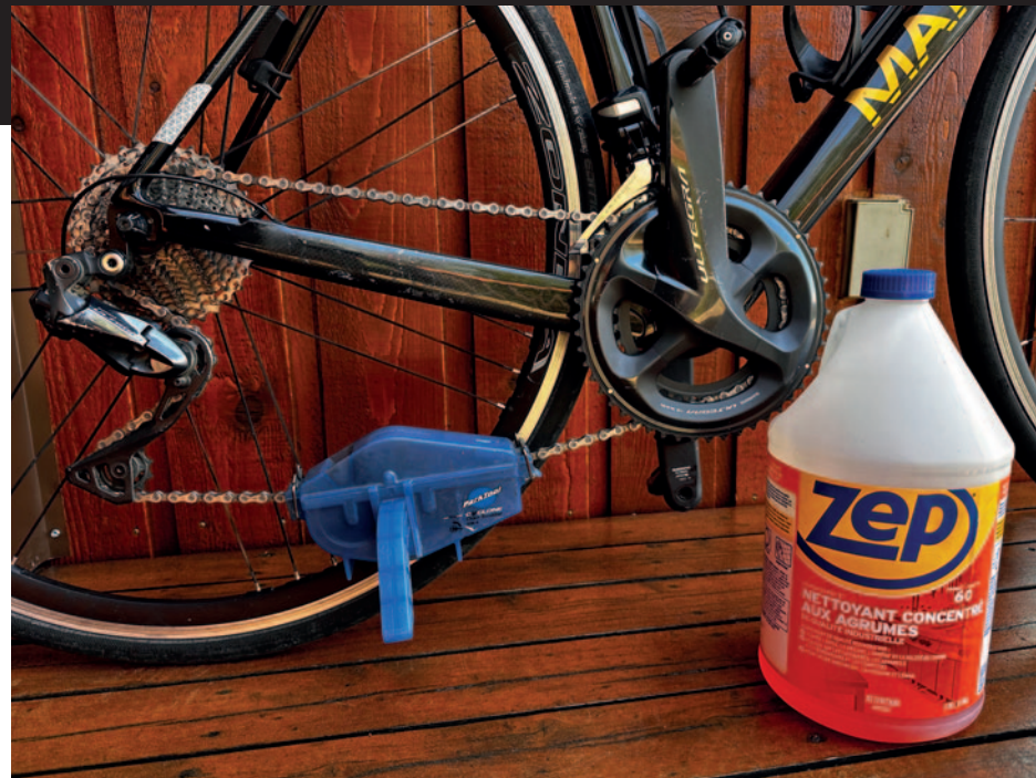
Un bain occasionnel de la chaîne dans le dégraisseur lui fait le plus grand bien!
