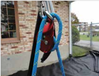
Installation du I.D. Petzel en opération de descente
