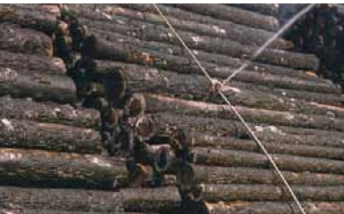
Arrosage constant des billes avec de l'eau recyclée de bassins créés artificiellement.
