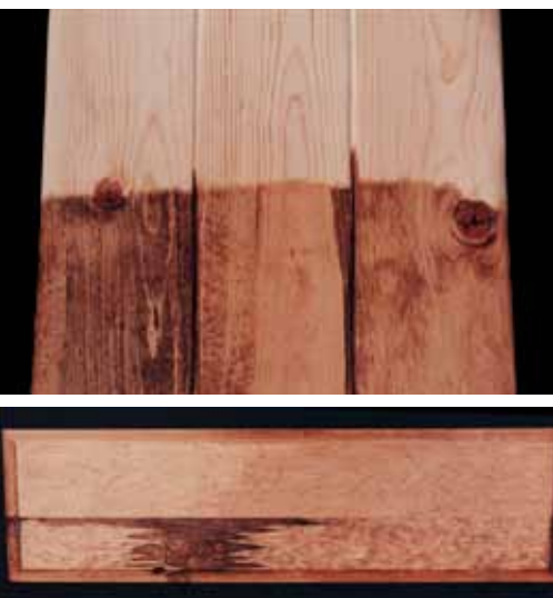
Les colorations bactériennes peuvent ne pas être évidentes avant l'application de la finition du bois. La zone touchée absorbera davantage de produit de finition et créera une plus grande tache saturée.
