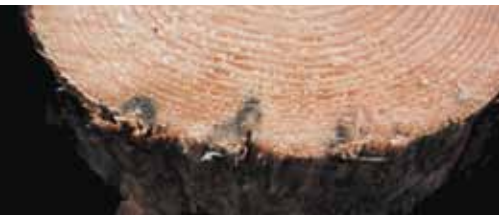
Indentations dans le bois accompagnées de débris de bois et d'écorce inoculés et de la croissance de champignons correspondante.
