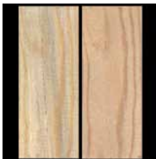
Bois bleui avant (à gauche) et après (à droite) l'avoir blanchi à l'aide d'hypochlorite de sodium.
