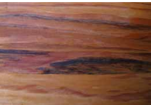
Tache minérale sur le bois débité sur dosse du Douglas taxifolié.
