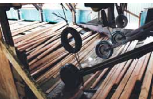
Traitement par immersion individuelle du bois d'œuvre. Cette technologie a désormais été remplacée par des systèmes d'immersion ou de vaporisation en continu, ou par des systèmes d'immersion en bassin.
