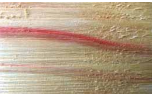
Coloration résultant de la diffusion d'un pigment du pin rouge dans le bois, due à l'espèce Fusarium .
