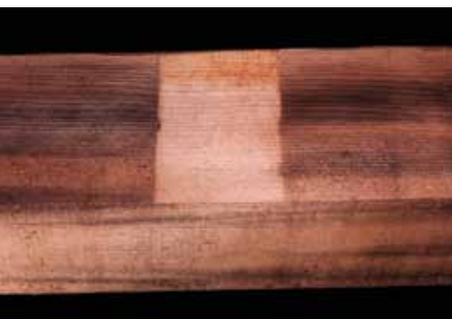
Tache de séchage sur la pruche occidentale. La zone plus claire est éliminée par rabotage pour montrer la couleur naturelle du bois.
