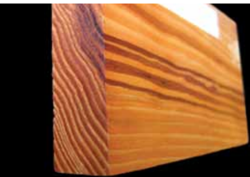
Tache minérale sur le bois débité sur quartiers du Douglas taxifolié.
