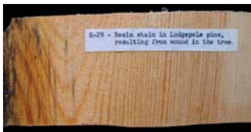
Traînée de résine dans le pin tordu résultant d'une blessure de l'arbre.
