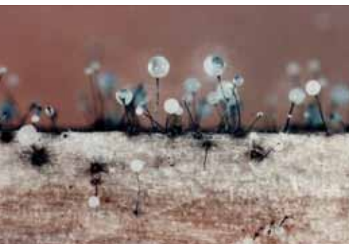
Structures sporiques responsables du bleuissement de surface avec grossissement 20X.
