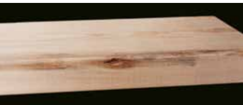
Trous dans une planche accompagnés de taches et de caries. Ils résultent de dégâts provoqués par les rouleaux de l'abatteuse sur l'extérieur des billes abattues. Les trous exposent l'intérieur du bois aux champignons présents dans les débris d'écorce, de bois et de feuilles.
