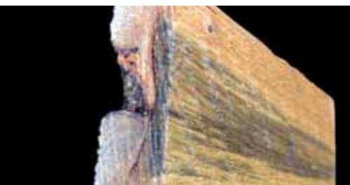
Traînée noire dans le pin tordu associée à la résine d'une blessure.
