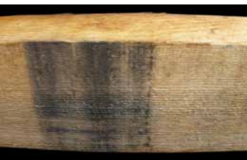
Tache de tannate de fer résultant de chaînes de transfert. Remarque : la tache est superficielle et peut être éliminée au moment du rabotage.
