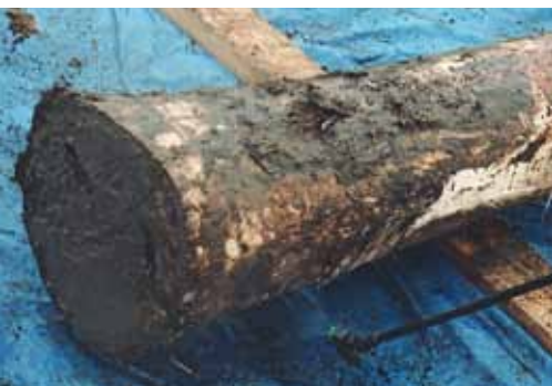
Pour de meilleurs résultats, la vaporisation doit s'effectuer dès que possible après la récolte. En cas de retard, surtout si les billes deviennent boueuses, elles sont préinfectées et la protection biologique ne fonctionnera probablement pas.
