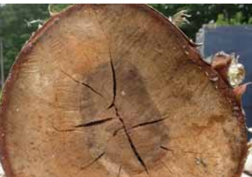
On peut voir apparaître des gerces indésirables sur les billes si celles-ci sont séchées rapidement.
