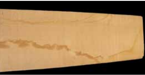
Tache d'eau sur une pièce de cèdre rouge de l'Ouest.
