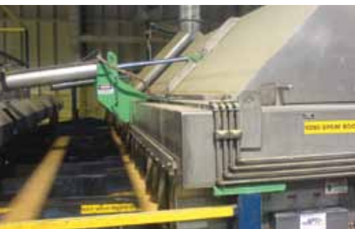
Poste de vaporisation transversale pour l'application individuelle de produits de protection contre les taches de sève.
