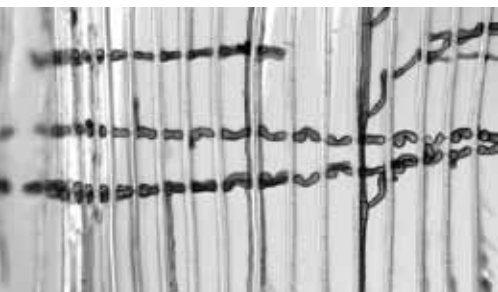
Image au microscope d'hyphes fongiques passant à travers les parois des trachéïdes, que l'on peut voir dans le bois du cèdre jaune touché par une coloration noire.
