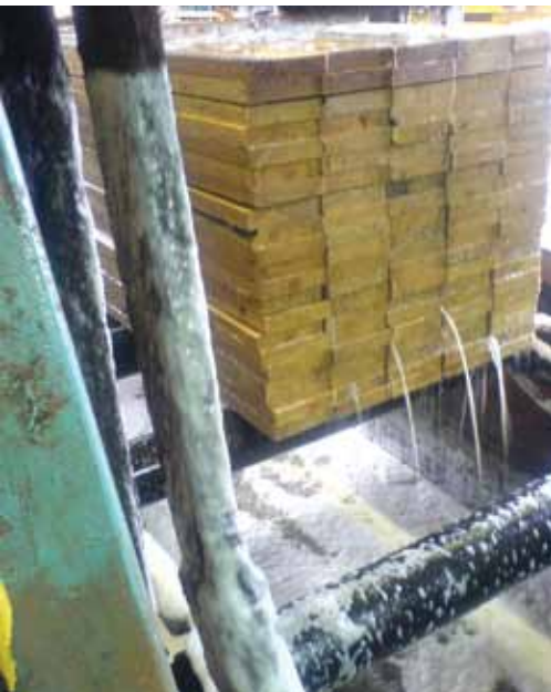
Traitement par immersion de paquet plein du bois d'œuvre.
