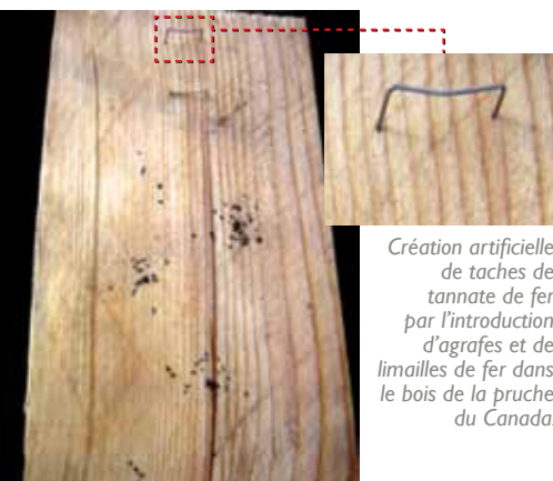
Tache de tannate de fer résultant de chaînes de transfert. Remarque : la tache est superficielle et peut être éliminée au moment du rabotage.
