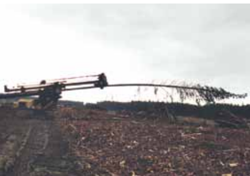
Ébranchage. Cette étape n'est pas effectuée dans la méthode du séchage biologique, où les arbres sont entreposés avec leurs branches pendant 1 à 2 mois après la récolte.
