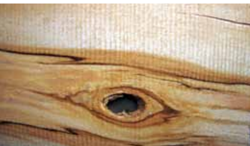
Coloration liée à la carie présentant des lignes de zone noires dans le peuplier faux-tremble.
