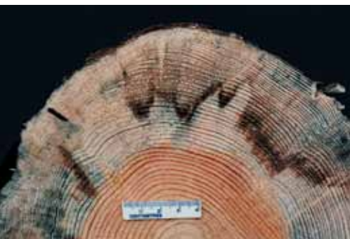
Tache de sève brune présentant un modèle de croissance semblable à celui des champignons responsables du bleuissement, chez le pin tordu.
