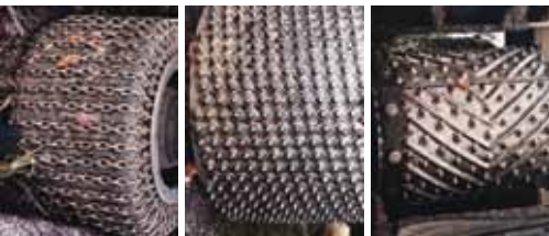
Différents modèles de rouleaux d'abatteuses, les chaînes sur le caoutchouc entraînent moins de dégâts que les pointes.
