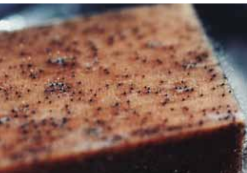
Structures sporiques responsables du bleuissement de surface avec grossissement 3X.
