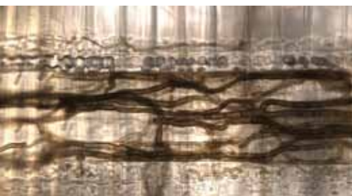
Vue au microscope de filaments fongiques à pigmentation foncée responsables du bleuissement dans le bois. Photo reproduite avec la permission de James Drummond.
