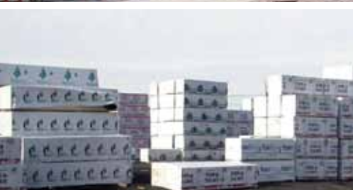
Moyens d'empêcher le bois d'œuvre sec de se réhumidifier par entreposage approprié (sous un abri ou correctement enveloppé).
