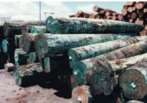
Billes protégées de façon chimique en Nouvelle-Zélande. Cette méthode ne peut être utilisée au Canada en raison de la réglementation en vigueur.
