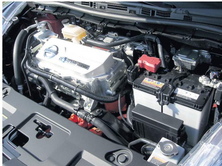
PHOTO ÉRIC DESCARRIES, COLLABORATION SPÉCIALE Nissan a donné l'apparence d'un moteur quatre cylindres ordinaire à son moteur électrique.
