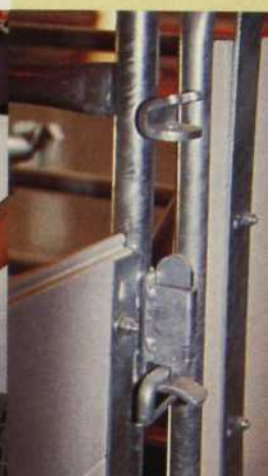
Le loquet de fermeture remplace les tiges de métal. Simple comme bonjour !
