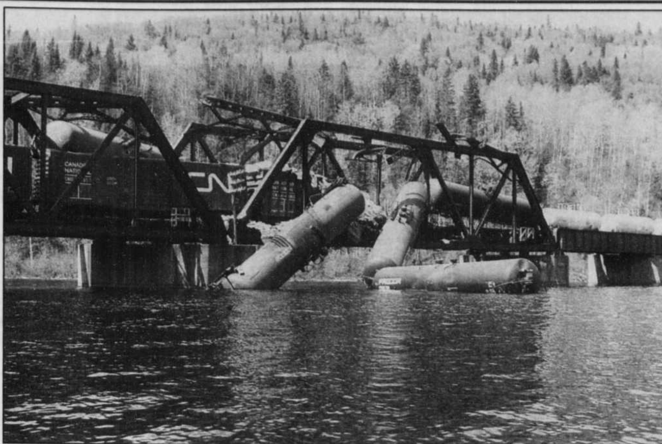
Photo PC Le déraillement du convoi ferroviaire du Canadien National, au nord de la centrale hydroélectrique Beaumont, hier, près de La Tuque, a causé bien des soucis aux travailleurs du Canadien National, qui ont dû composer avec une structure de pont lourdement endommagée.
