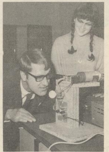
Appareil de Millikan servant à mesurer la charge d'un électron.
