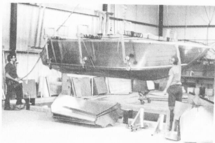
Maux de dos, risques d'accidents, perte de temps... autant de problèmes qui ont été résolus par des appareils de manutention et de positionnement qui permettent également une qualité accrue. Une idée des gens de chez Altra, une réalisation de Belcraft et tout le monde y gagne. Auparavant, ces opérations étaient faites à la main.
