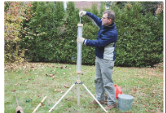
Perméamètre : l'essai de conductivité hydraulique permet de déterminer le niveau de perméabilité du sol.
