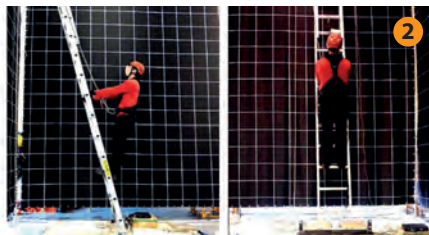
Vérification de la stabilité de l'échelle – Position 1 : reculé (P1).
