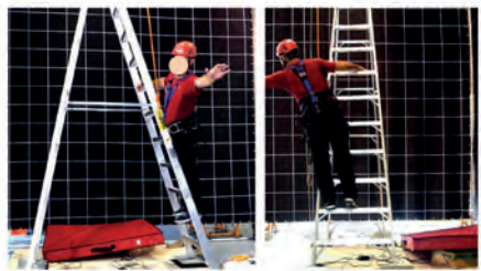
Vérification de la stabilité de l'escabeau – Position 2 : côté (P2).
