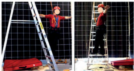
Vérification de la stabilité de l'escabeau – Position 3 : retourné (P3).
