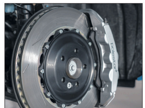
Le freinage à l'essieu avant comprend des étriers Brembo à 6 pistons et des disques de 371 mm.
