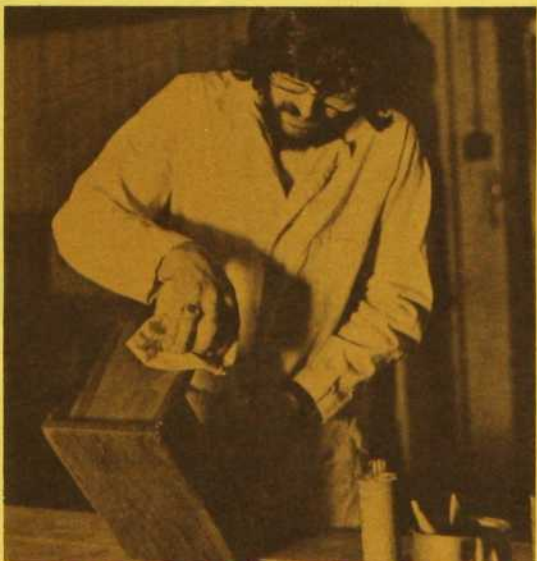
La finition à l'huile — On va donner à ce petit banc en pin une couche d'huile de lin bouillie raffinée et conserver ainsi sa couleur blonde si chaleureuse.
