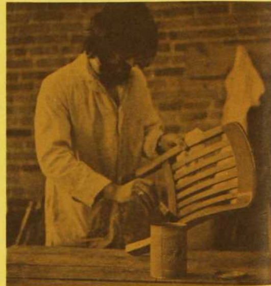
La finition à la teinture — Le dossier d'une chaise en érable (dont on a tout à l'heure décoloré le siège) reçoit ici une teinture orangée.
