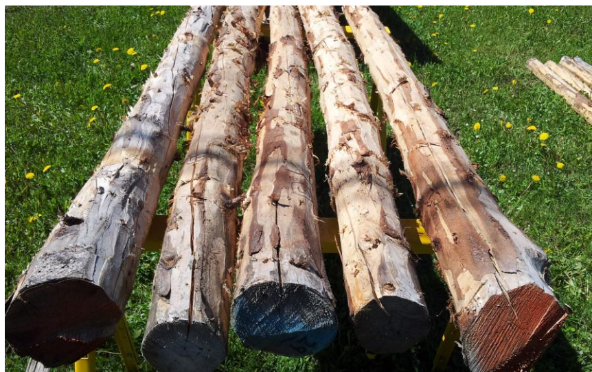
Figure 15. État de fissuration des billes séchées à l'air libre
