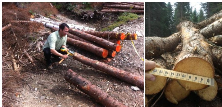
Figure 1. Mesure des dimensions et du MOE dynamique par le système Director HM200
