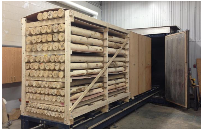
Figure 3. Empilement des billes pour le séchage conventionnel
