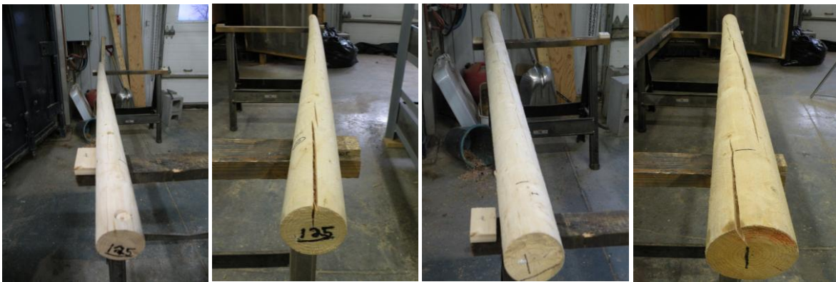
Figure 11. Exemples types de fissures dues au séchage conventionnel
