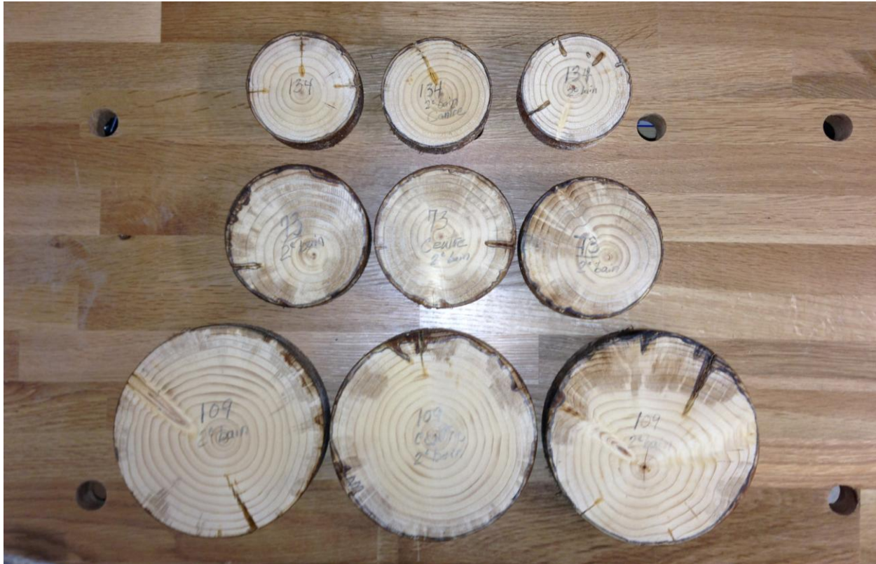
Figure 16. Sections de billes imprégnées d'huile de lin par oléothermie
