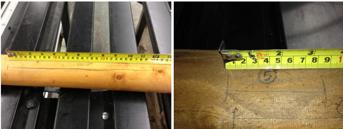
Figure 13. Exemples types de fissures produites lors du séchage à l'huile
