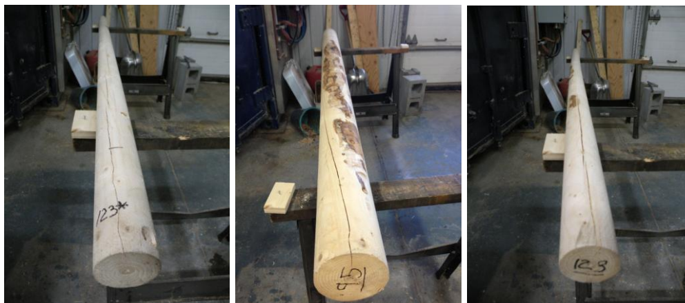
Figure 9. Exemples types de fissures dues à l'amorce du séchage avant tournage
