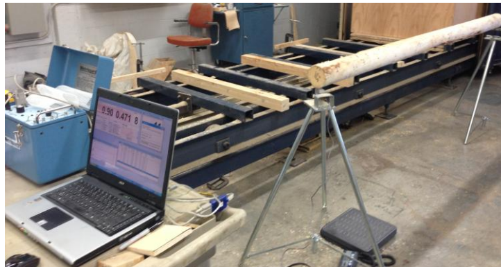
Figure 7. Mesure du MOE par le dispositif Metrigard
