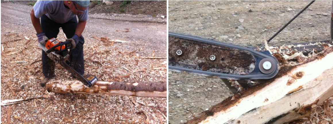
Figure 2. Écorçage manuel des billes
