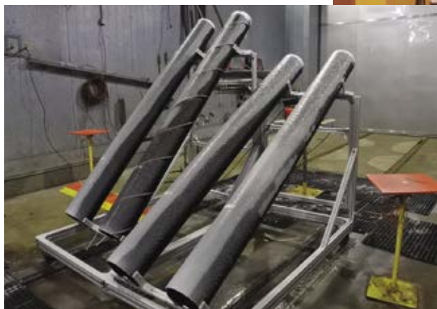
◀ Modèles de câbles de pont à haubans exposés à la pluie verglaçante dans l'installation d'essais climatiques du CNRC Photo : CNRC
