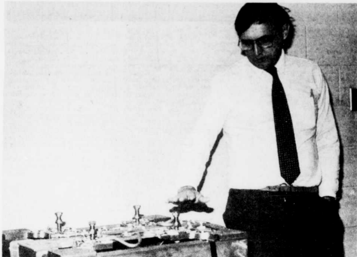
Le professeur Bourassa montrant un appareil mettant de mesurer les efforts distribués au sol qui constituera une plate-forme de forces lors de la marche à pied.
