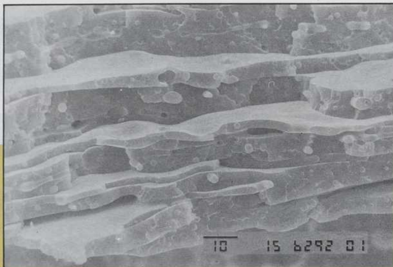
Structure multicouche vue au microscope électronique
