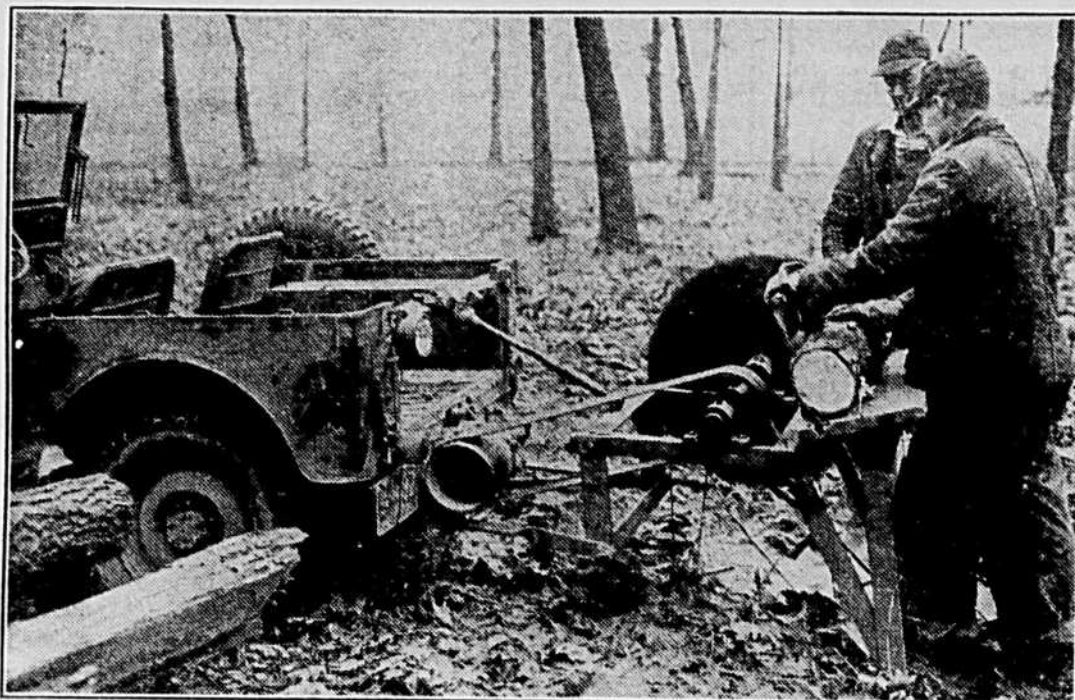
La scie ronde n'échappe pas aux multiples aptitudes de la "jeep". L'on peut voir très distinctement l'endroit de la poulie. Ce dispositif peut également actionner un compresseur et une perforeuse de fabrication spéciale. (Photo Willys-Overland)
