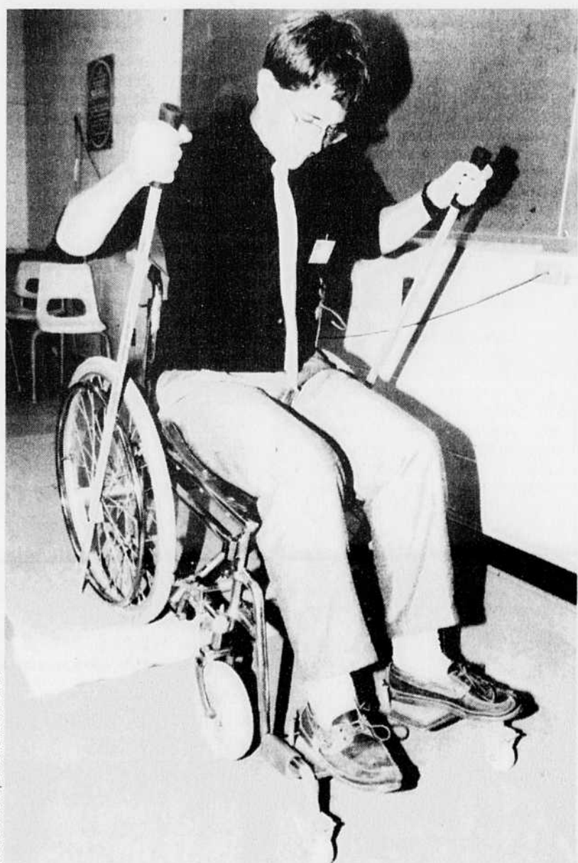
Dominique Frigon, vice-président aux finances de la compagnie Montelatsu, montre le fonctionnement du prototype de la «sauterelle», permettant à un fauteuil roulant de franchir une marche.
