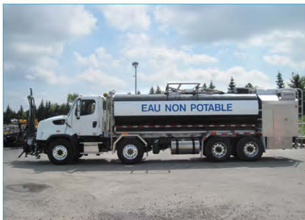
■ Le CGER désire demeurer à la fine pointe de la technologie en matière de véhicules automobile et de machinerie lourde. Pour ce faire, il offre maintenant le camion-citerne double vocation avec citerne en polymère à sa clientèle.
