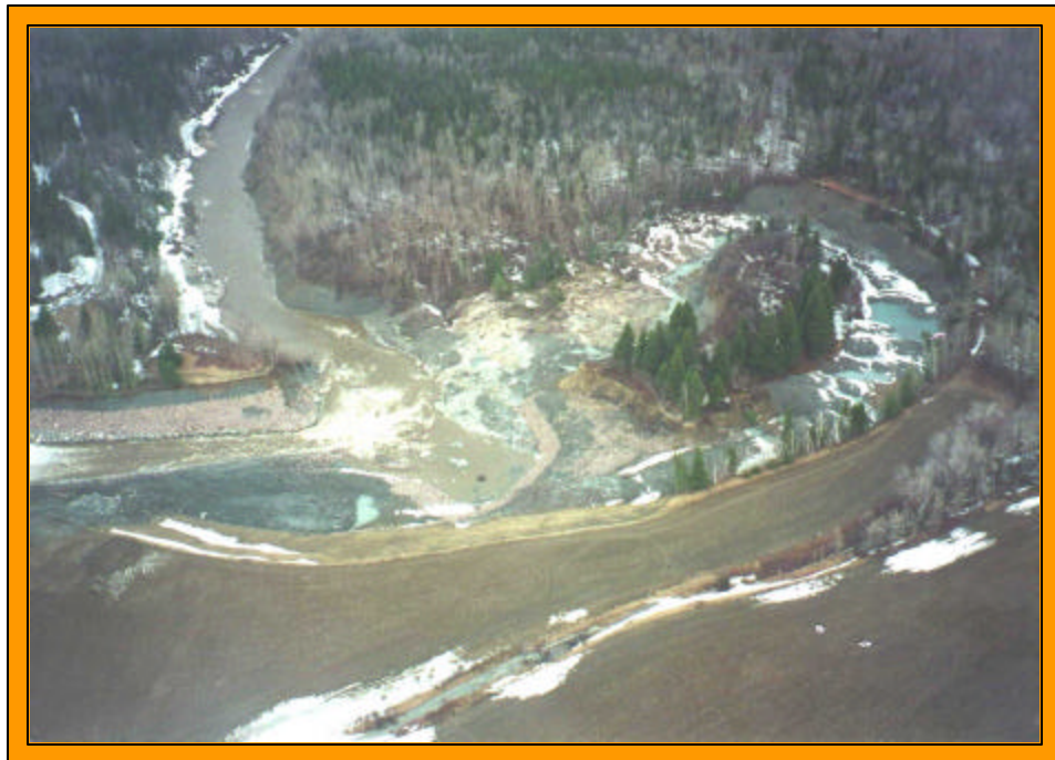
B : Vue du changement du cours de la rivière et du méandre abandonné. À cause de l'érosion régressive, les falaises d'argile sensible en amont ont dû être
