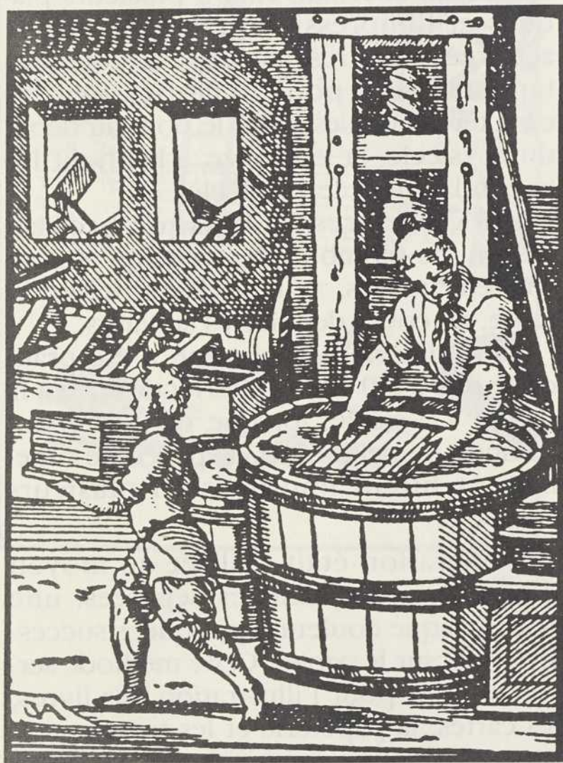
Cette xylographie, due à Josse Annam et imprimée à Francfort en 1568, est la première représentation de la fabrication de papier en Europe. Cette gravure montre l'extraordinaire ressemblance qui existe entre les outils et les procédés utilisés par les papetiers européens et ceux en usage des siècles auparavant en Chine. Illustration tirée de "Old Papermaking" par Dard Hunter, Mountain House, 1923.
