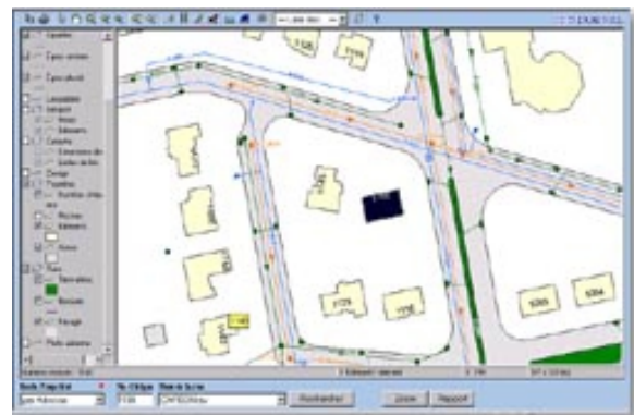
Les réseaux d'égout, d'aqueduc, les bordures, les trottoirs.
