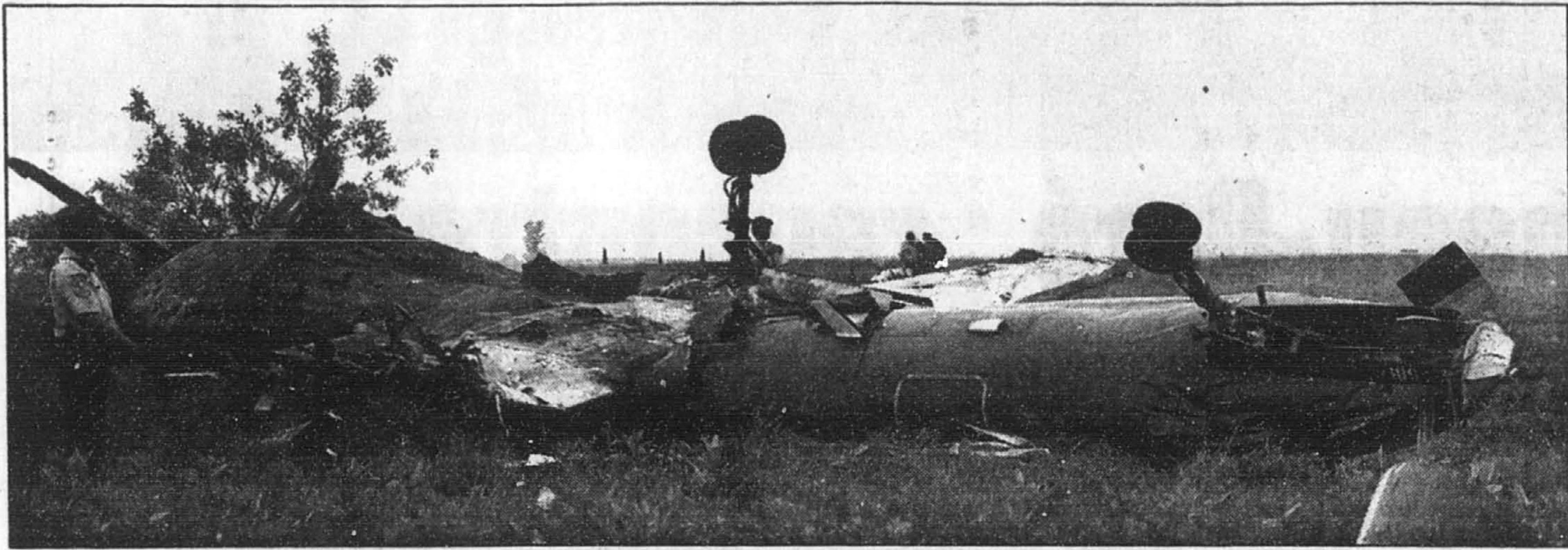
L'examen de l'épave a révélé la présence d'importants dommages ayant été causés par le feu dans le logement de train d'atterrissage gauche de l'avion de Propair avant l'écrasement.
