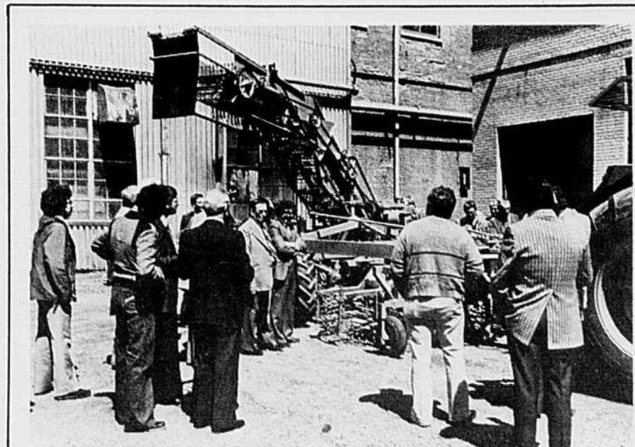
L'arracheuse-récolteuse Herriau, qui a été présentée aux producteurs de betteraves lors de l'inauguration des travaux d'agrandissement et de modernisation de la Raffinerie du Mont Saint-Hilaire. Grâce au système "poussé-trainé" dont est munie la machine, les betteraves sont manipulées plus délicatement qu'auparavant.
