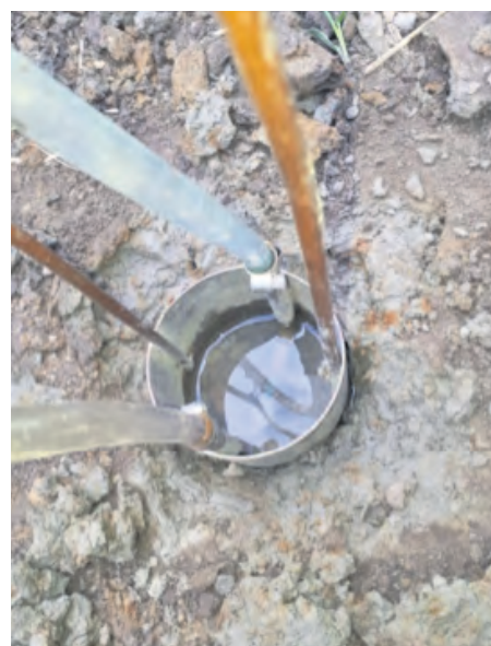
Que ce soit en utilisant des cylindres de PVC (A), l'infiltromètre de Côté (B) ou l'infiltromètre de Guelph (C), le constat est le même : l'eau de surface ne s'infiltré que très lentement dans le sol. Photos : Bruno Garon
