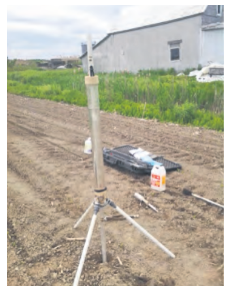
Que ce soit en utilisant des cylindres de PVC (A), l'infiltromètre de Côté (B) ou l'infiltromètre de Guelph (C), le constat est le même : l'eau de surface ne s'infiltré que très lentement dans le sol. Photos : Bruno Garon
