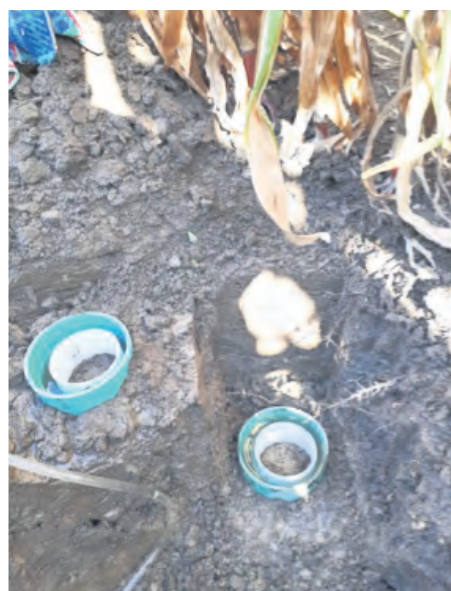
Que ce soit en utilisant des cylindres de PVC (A), l'infiltromètre de Côté (B) ou l'infiltromètre de Guelph (C), le constat est le même : l'eau de surface ne s'infiltré que très lentement dans le sol. Photos : Bruno Garon
