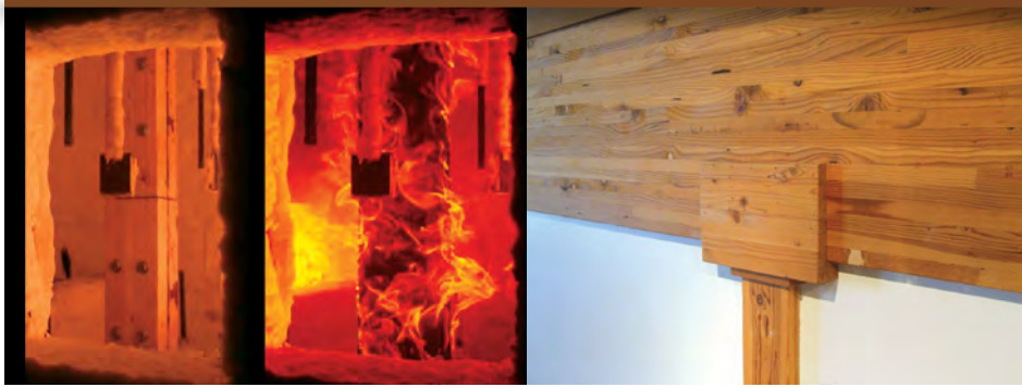
Figure 5 Attaches protégées pour une résistance au feu accrue
