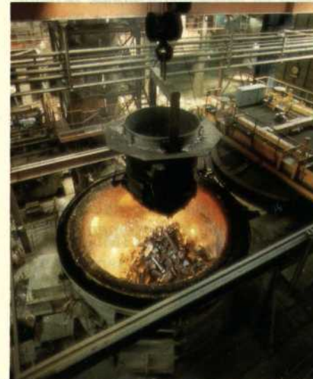
Four à arc à l'usine Citroën (capacité de 23 tonnes)
