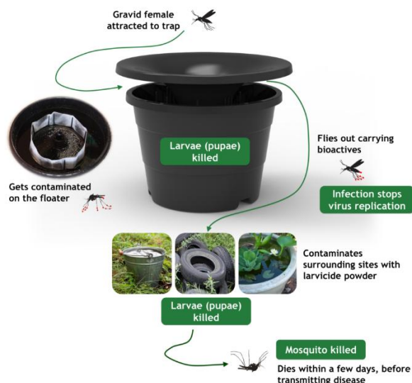
Figure 6. Fonctionnement du piège In2Care 554
