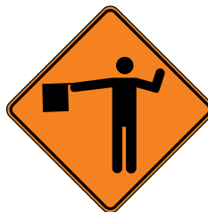
Signal avancé d'un signaleur
