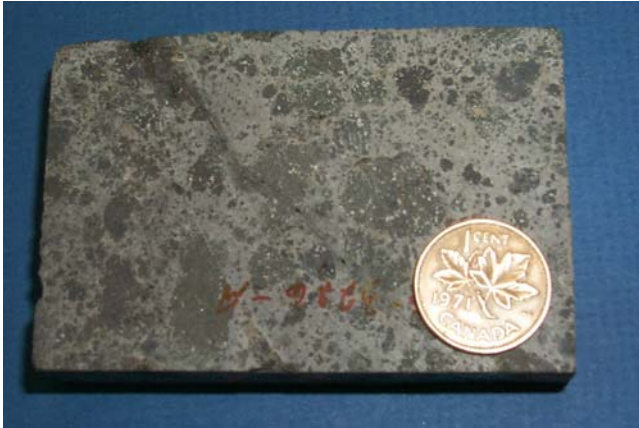
Photo 1 - Brèche de coulée andésitique à fragments de lave gris foncé incorporés dans une matrice de lave gris pâle de même composition. Les fragments sont composés de verre enrobant des microlithes de feldspath. On peut voir dans les fragments et la matrice une texture fluidale produite par l'alignement des microlithes de plagioclase.
