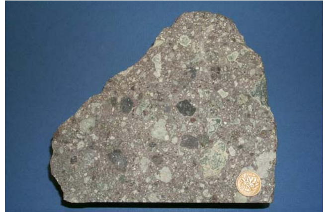
Photo 2 - Tuf à lapilli ou à blocs contenant des fragments constitués principalement de lave porphyrique gris verdâtre, noire ou parfois grisâtre. La matrice est formée de microfragments de même composition et de cristaux libres enrobés dans une pâte aphanitique plus ou moins opaque. La présence d'hématite dans la matrice donne à la roche une teinte rougeâtre.
