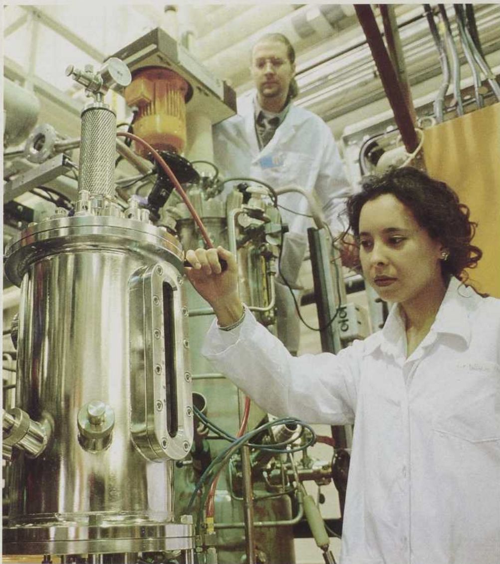
Travail sur un bioréacteur de 20 litres pour la production de protéines recombinantes à l'IRB
