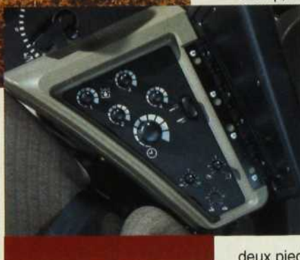
En activant un bouton, l'opérateur peut commander chacune des valves hydrauliques.
