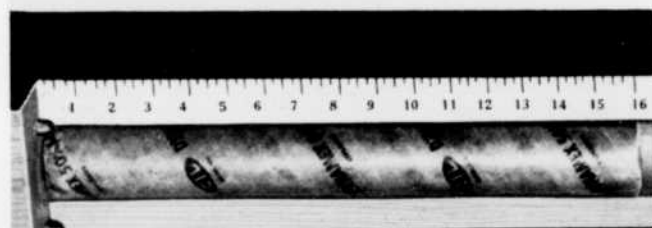
Cartouche PAK-TITE* (2" x 16") dans un trou de mine simulé, avant le bourrage.
