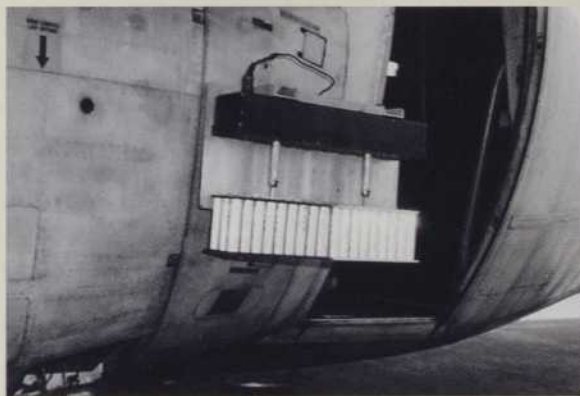
C'est un simple appareil fixé aux avions-cargos pendant la guerre du Viêtnam, qui permettait le largage de l'iode d'argent. Cette substance favorise la création de nuages.
