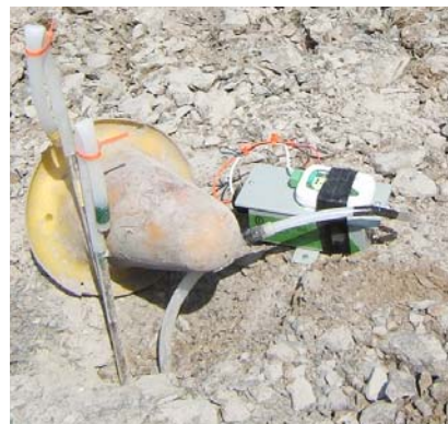
Figure 6 : (a) Appareil BaroLufft pour les mesures de pressions absolues dans l'air ambiant et extérieur (b) Appareil PX-30DI pour des mesures de pressions différentielles dans les puits.
