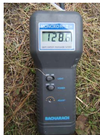
Figure 4 : (a) Prise de mesure de concentration en CO dans un puits avec un détecteur MONOXOR II (b) détecteur MONOXOR II
