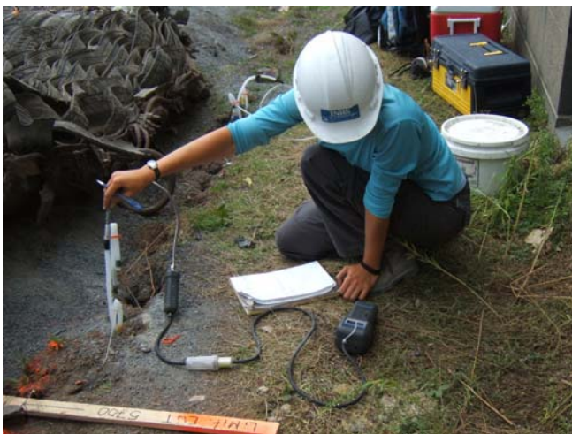
Figure 4 : (a) Prise de mesure de concentration en CO dans un puits avec un détecteur MONOXOR II (b) détecteur MONOXOR II
