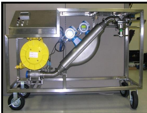
Figure 28. Exemple d'un ensemble utilisé par Endress+Hauser Canada pour la vérification et la certification des débitmètres dans l'industrie
