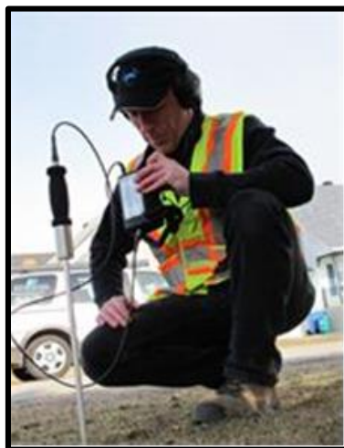
Figure 9. Écoute sur robinet d'arrêt
