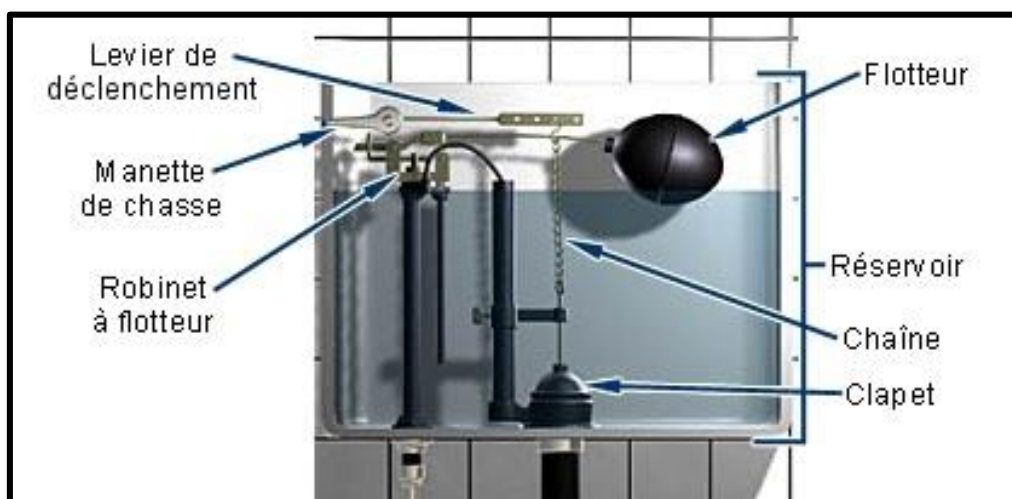
Figure 14. Les éléments du mécanisme d'une toilette
