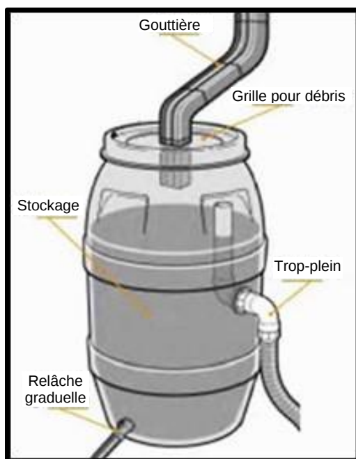
Figure 20. Composantes d'un baril récupérateur d'eau pluviale
