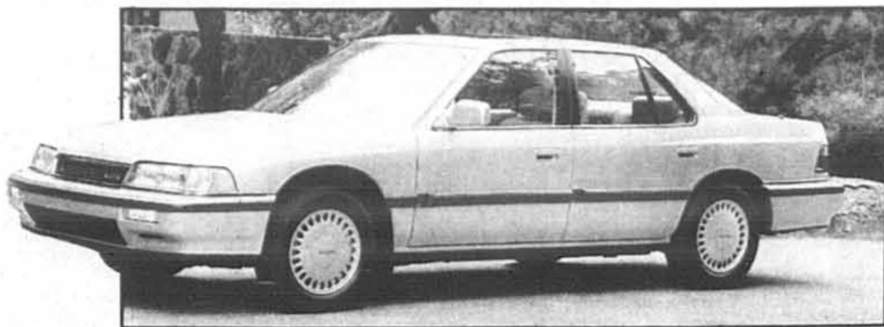
La Legend berline chez Acura est pourvue d'une nouvelle suspension arrière afin d'améliorer son comportement routier.
