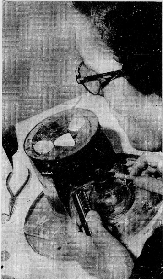
POUR FIXER LA PIERRE à la boucle d'oreille ou au cadre de métal, le cabochon est chauffé sous la flamme d'un brûleur et enduit de cire d'Espagne. Pour les pierres translucides, une cire incolore est utilisée pour ne pas altérer les reflets. Les procédés de fabrication de bijouterie en pierres semi-précieuses ressemblent à ceux suivis pour les diamants. (Photo Champlain Marciel)
