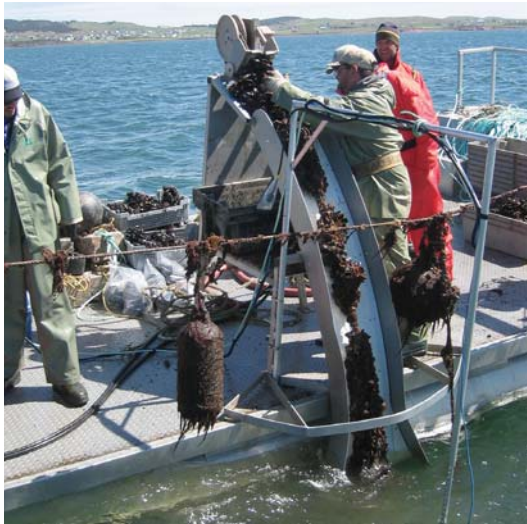
Photo 1 : Rampe utilisée par Moules de Culture des Îles lors des récoltes. La tige à l'avant était munie d'une caméra fixe qui filmait l'interface air-eau.
