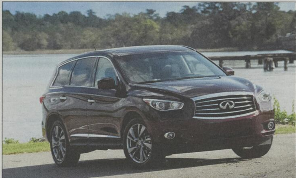
Le nouveau JX35 d'Infiniti peut accueillir sept personnes grâce à ses trois rangées de sièges. Le V6 de 3,5 l (265 ch) est jumelé à une boîte CVT et un rouage intégral.
