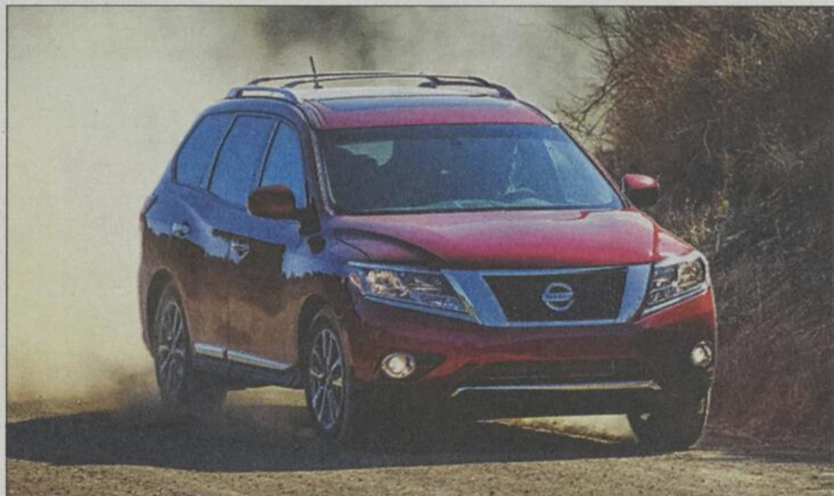
Le Pathfinder abandonne son châssis en échelle en 2013 pour une plateforme monocoque. Le nouveau V6 de 3,5 l demeure jumelé à une boîte CVT. La capacité de remorquage atteint 2268 kg.
