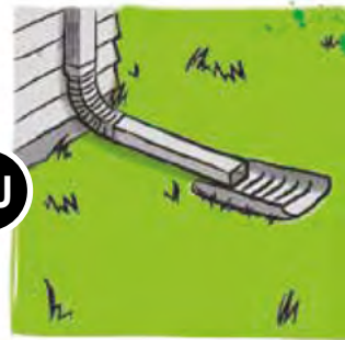
Un déflecteur d'eau de pluie en béton, en bois ou en vinyle.
