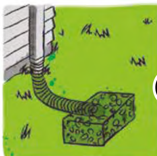
Un puits percolant à plus de 1,5 mètre de la résidence.
